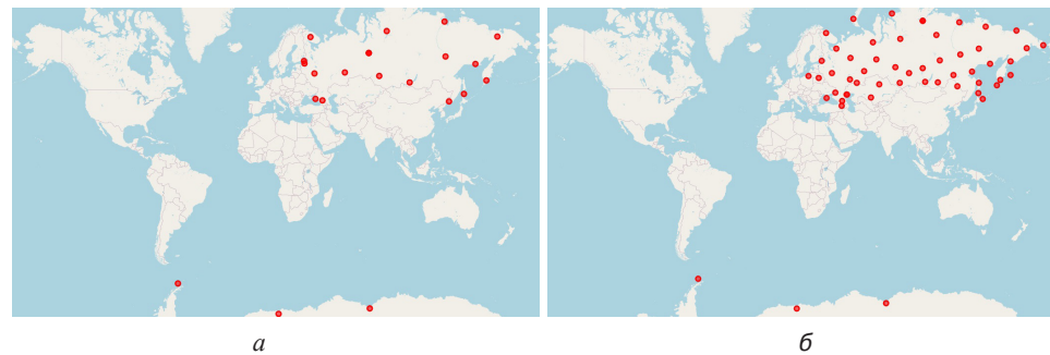
Рис. 1. Сети станций СДКМ предыдущего этапа (а) и текущая сеть СДКМ-КФД (б)
