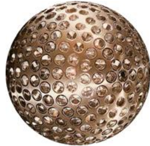
LAGEOS-1: Диаметр – 60 см Вес – 407 кг Орбита – 5860 км
