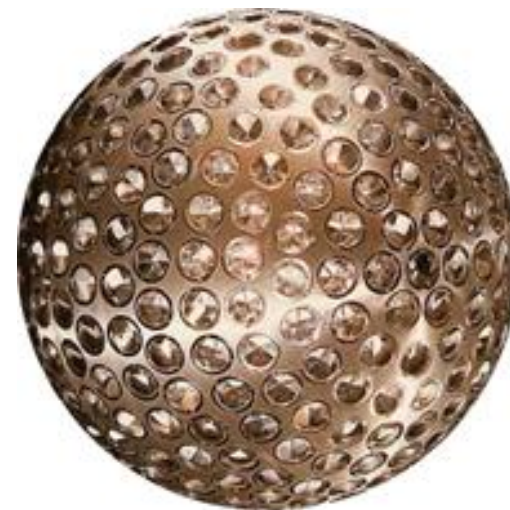
LAGEOS-1 : Диаметр – 60 см Вес – 407 кг Орбита – 5860 км
