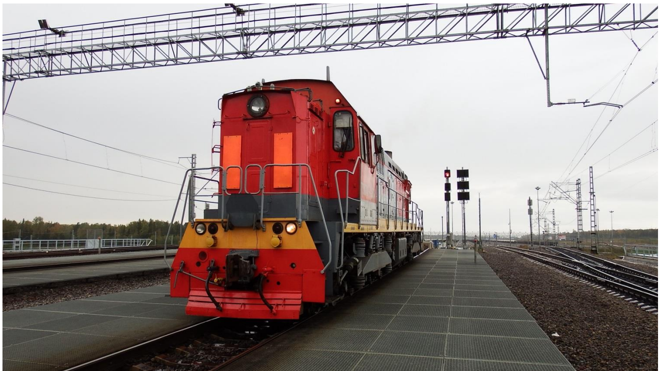
Рисунок 5 Маневровый тепловоз, на котором устанавливались испытываемые образцы НАП
